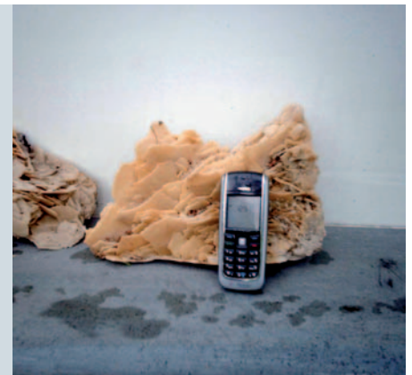
BILD 1: Kalkablagerungen aus einer Kunststoff-Rohrleitung DN 150 nach Complex-Reinigung: ausgebauter Flanschbogen (links); entfernte Kalkablagerungen (Mitte); Größenvergleich (rechts)
