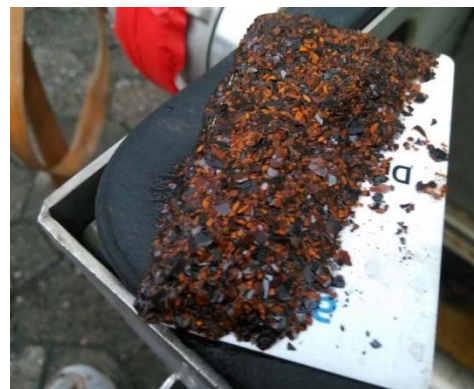
Abbildung 3: aus dem System ausgetragene Eisenpartikel
