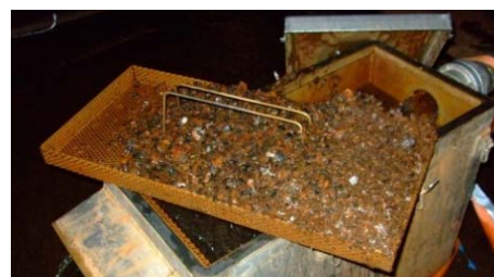
Abbildung 4: ausgetragene Ablagerungen in Spülbox
