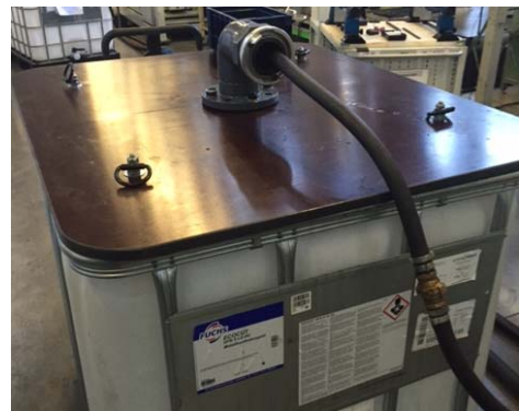
Abbildung 3: Ausspeisung in bereitgestellte Behälter (IBC)
