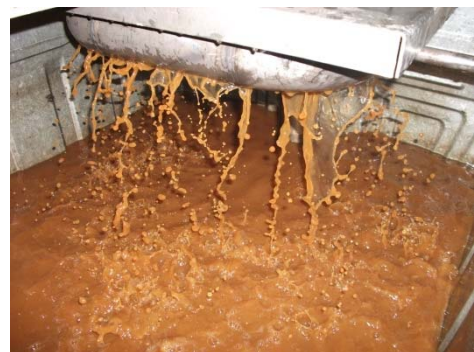
Abbildung 4: Ausspeisung von Luft und Spülwasser in Dekompressionsbox
