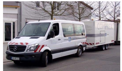
Abbildung 1: Complex ® -Einheit zur Bereitstellung von Druckluft
