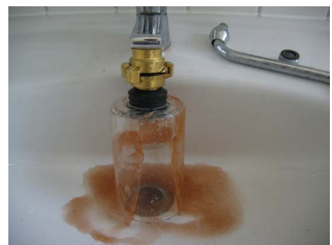
Abbildung 3: Trübung bei Ausspeisung über Waschbecken
