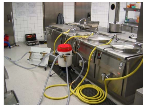
Abbildung 2: zentrale Ausspeisung der Mensa-Zapfstellen über Zyklonabscheider
