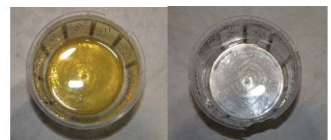
Abbildung 5: Spülwasserprobe zu Beginn (links) und am Ende der Reinigung (rechts)
