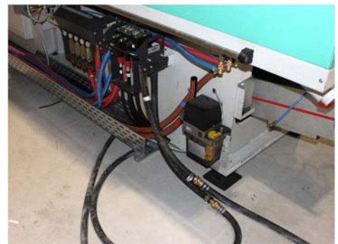
Abbildung 3: Anschluss an Kühlsystem über Adapteranschlüsse
