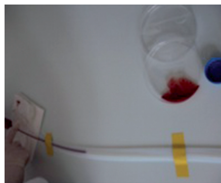
Abb. 3: Beimpfung der Prüfkörper (Quelle: Dissertation M. Steichen 2014)
