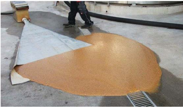
Abbildung 7: Trübung an Auslaufbox mit Spülsack
