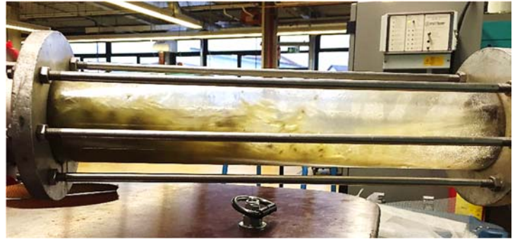
Abbildung 1: Trübung in Schauglas während der Reinigung
