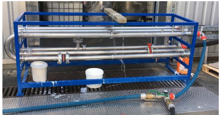
Abbildung 1: Teststrecke mit Rohrleitungssystem für Lacke
