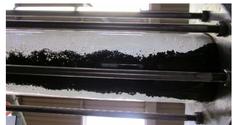
Abbildung 4: Grobpartikel in Schauglas am Ende der Reinigung
