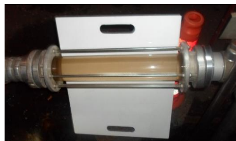
Abbildung 3: Trübung in Schauglas während der Reinigung
