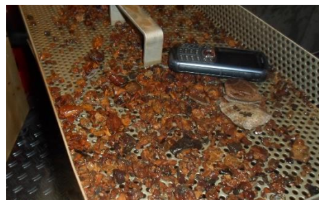
Abbildung 5: aus Rohrleitung ausgetragene Grobpartikel
