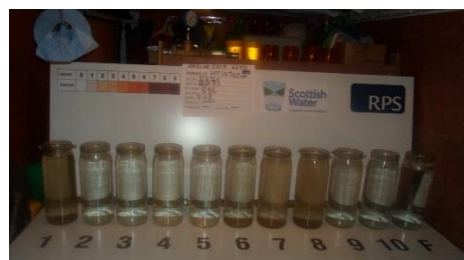
Abbildung 4: Trübungsmessung im Verlauf der Reinigung
