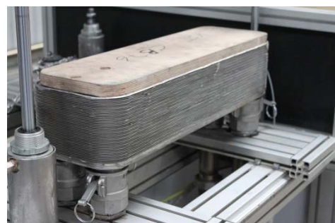
Abbildung 3: gelöteter Plattenwärmeübertrager auf dem Reinigungsstand
