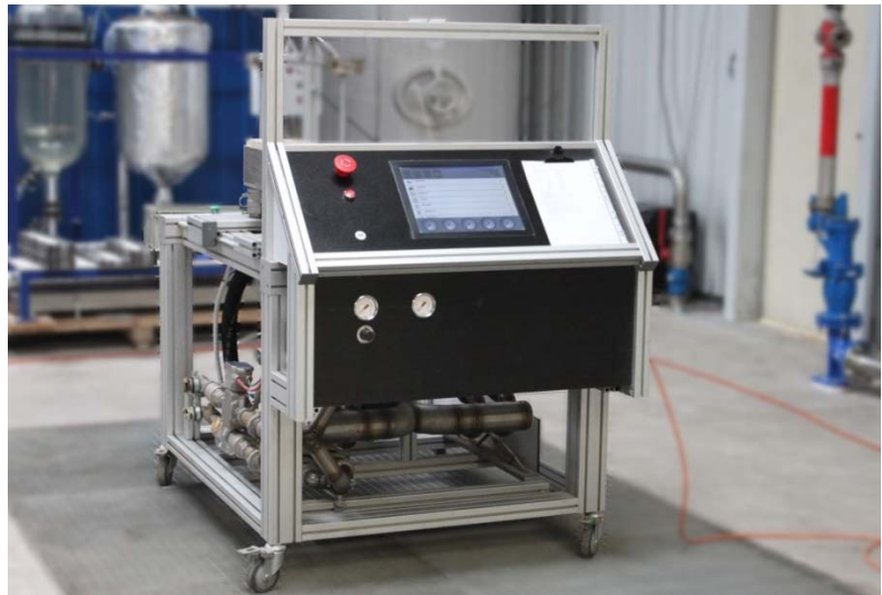
Abbildung 1: mobiler Reinigungsstand für Wärmeübertrager
