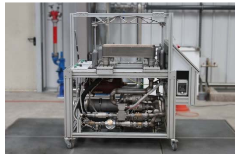
Abbildung 2: mobiler Reinigungsstand für Wärmeübertrager in der Seitenansicht
