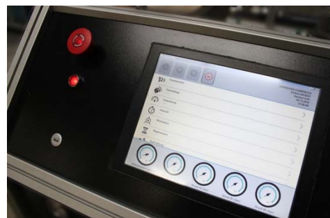
Abbildung 4: integrierter Touchscreen-PC für Steuerung und Dokumentation
