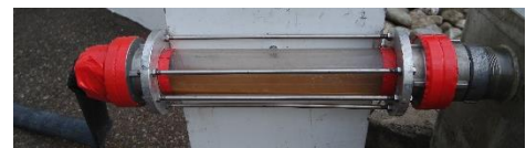
Abbildung 4: Trübung während der Reinigung
