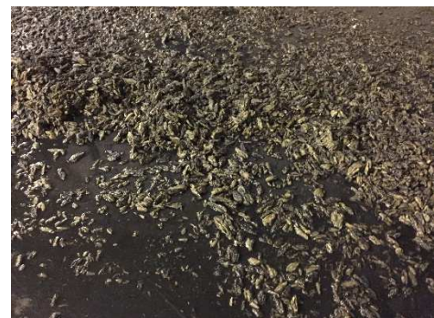
Abbildung 4: Ausspeisung der Ablagerungen in Pumpensumpf
