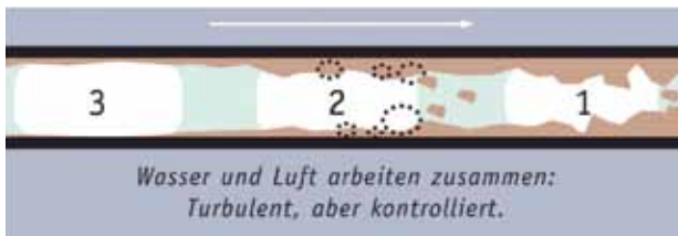
Abb. 5: Mobilisieren der Ablagerungen durch Luft- und Wasserblöcke
