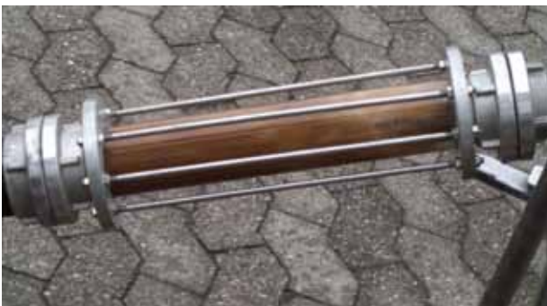
Abb. 1: Trübes Spülwasser im Schauglas während der Complex-Reinigung
