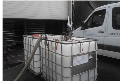
Abbildung 5: Auspeisung in bereitgestellte Behälter (IBC)
