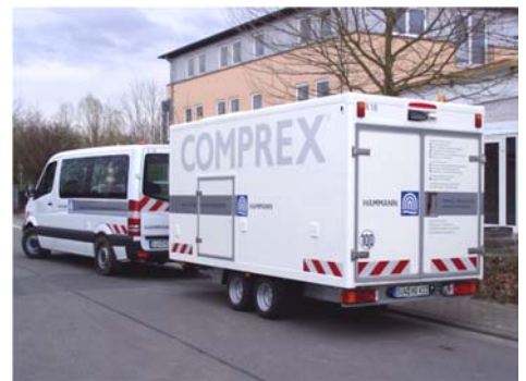
Abbildung 1: Complex ® -Einheit zur Bereitstellung von Druckluft
