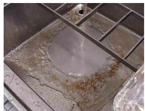
Abbildung 3: aus dem System ausgetragene Partikel an Zapfstelle
