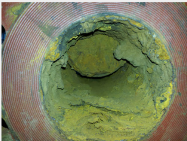
Bild 3: Weichdichtender Schieber, Bildnachweis: TU Berlin, FG Fluidsystemdynamik; DVGW-Forschungsprojekt W8/02/10 „Zustandsorientierte Instandhaltung erdverlegter Armaturen in der Wasserverteilung“; mit freundlicher Genehmigung
