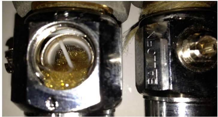
Abbildung 1: Ionentauscherharz in geöffneter Armatur
