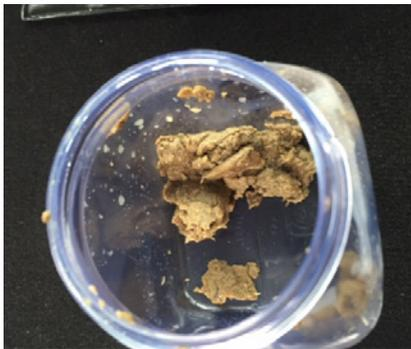
**Bild 4:** Aus dem Kühlsystem ausgetragene Ablagerungen (Beispiel 1)
