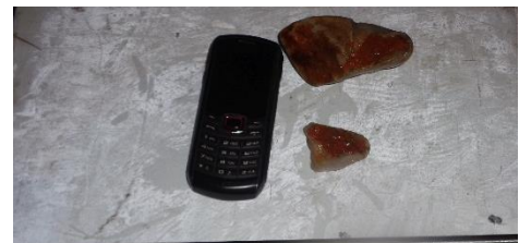
Abbildung 5: aus Rohrleitung ausgetragene Grobpartikel
