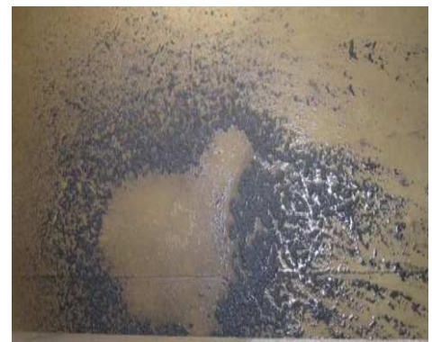
Abbildung 4: ausgetragene Späne und Partikel in Container
