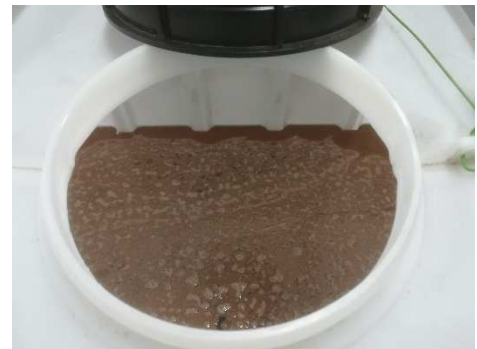
Abbildung 4: ausgetragene Partikel und Durchflusstrübung zu Anfang der Spülung
