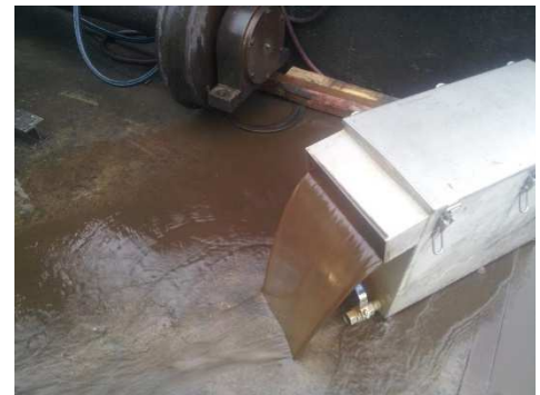
Abbildung 2: Trübung an Auslaufbox während der Reinigung
