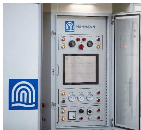
Abbildung 3: Steuerung der Impulse
