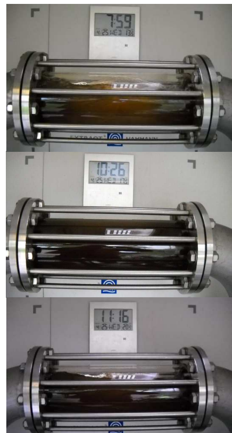
Abbildung 3: Trübung in Schauglas während der Wasser-Saug-Spülung
