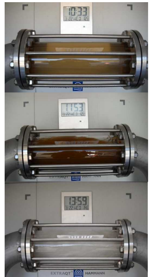
Abbildung 3: zeitlicher Verlauf der Trübung während der ExtraQt®-Reinigung
