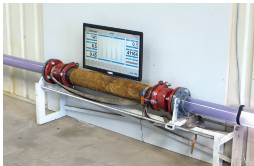
Abb. 10: Reale Rohrleitungsprobe in der Versuchsanlage
