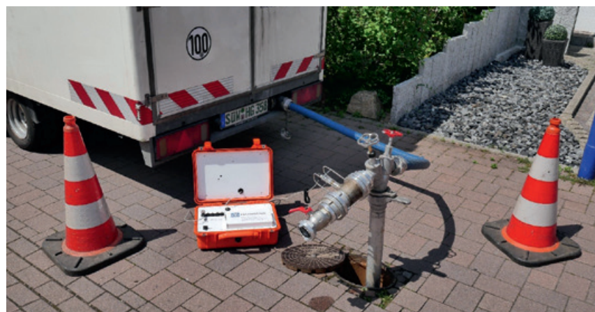
Abb. 11: Druckmessung eines Rohrleitungsabschnitts mittels Messbox in der Praxis
