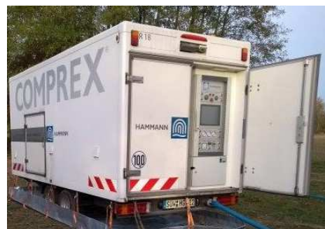
Abbildung 2: Steuerung der Impulse durch Comprex®-Einheit
