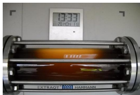
Abbildung 3: Trübung in Schauglas während der ExtraQt®-Spülung
