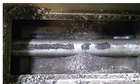
Abbildung 4: Feinpartikelaustrag aus dem Kühlmantel
