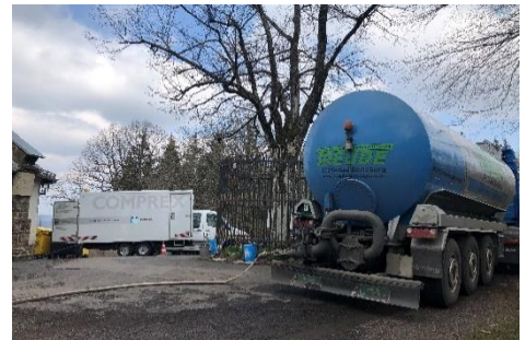
Abbildung 2: Spültankfahrzeug zum Bereitstellen des Spülwassers
