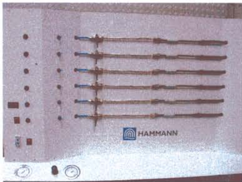
Abb.1: Silikonschlauchmodell mit Biofilm in der Versuchsanordnung zur Untersuchung des Impuls-Spül-Verfahrens Abb.2: Plexiglashüllen zum Schutz der flexiblen Silikonschläuche
