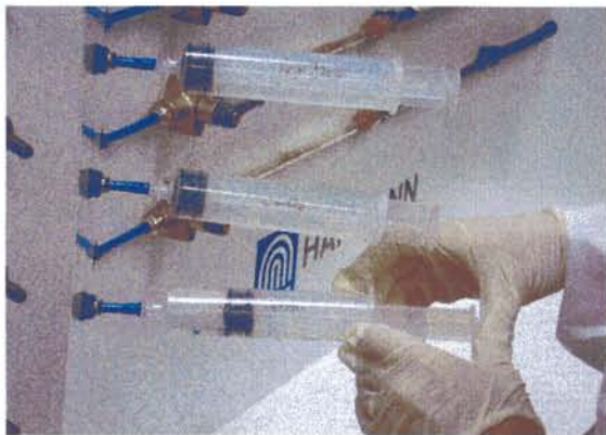
Abb.3:Manuelle Zudosierung von je 30 ml Desinfektionsmittel
