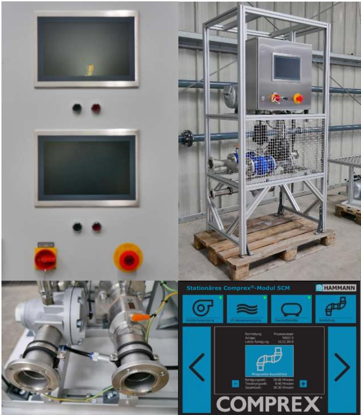
Abbildung 5: Weitere Ansichten des Stationären Compress®-Moduls (links oben: Kombi-Schaltschrank zur Steuerung von zwei Wandmodulen; rechts oben: Stand-Alone Ausführung; links unten: Flanschanschlüsse; rechts unten: Beispiel für Compress-Software)
