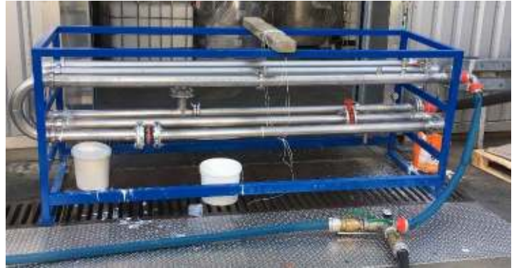
Abbildung 1: Teststrecke mit Rohrleitungssystem für Lacke
