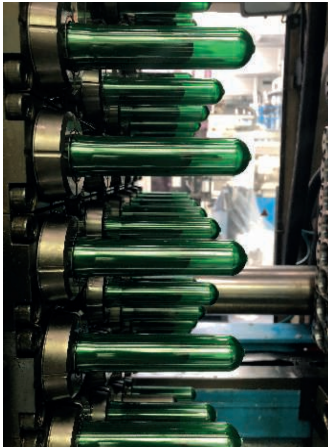
Multi-Kavitäten-Werkzeug zur Herstellung von Preforms für PET-Flaschen
