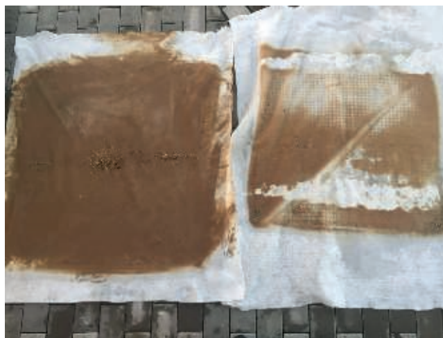
Bild 4. Zwei mit ausgetragenen Partikeln beladene Filtervliese. Diese können bedenkenlos entsorgt werden
