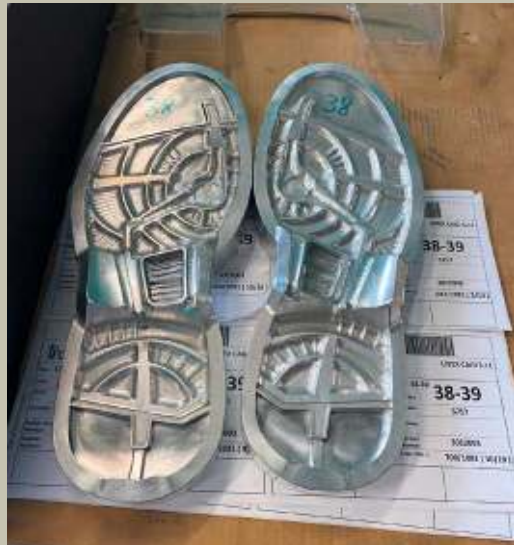
Bild 4: Beispiel für Spritzgießwerkzeug und Werkzeugeinsatz für Schuhsohle
