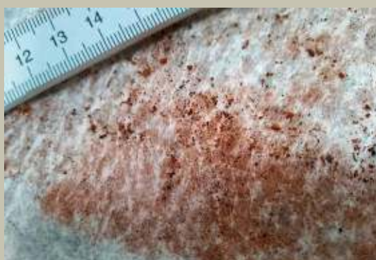
Bild 5: Ausgetragene Feststoffe aus Spritzgießwerkzeug auf Filtervlies
