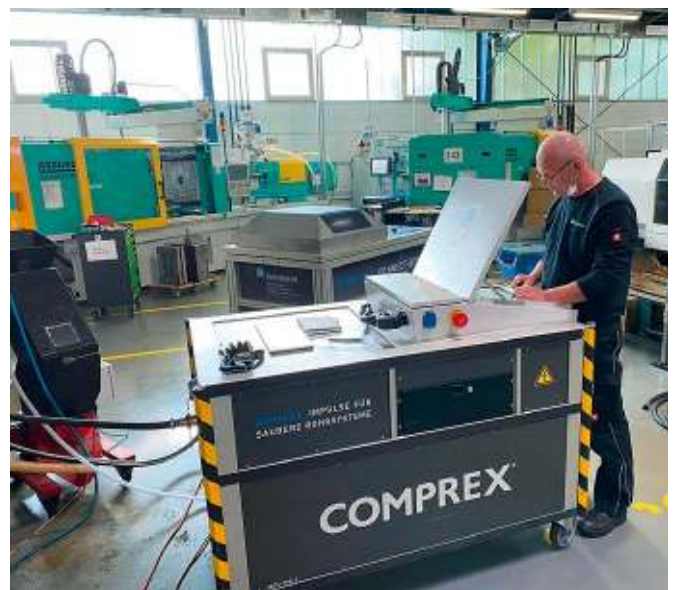
Bild 1: MCU-300 während der Reinigung der Werkzeug- und Maschinenkreisläufe
