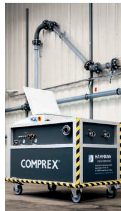
Die mobilen Comprex-Units MCU-20 und MCU-300 kommen abhängig von Nennweite und Rohrleitungslänge zum Einsatz.
