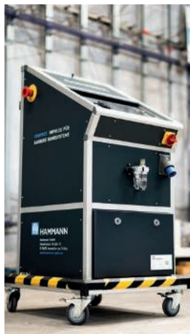
Die mobilen Comprex-Units MCU-20 und MCU-300 kommen abhängig von Nennweite und Rohrleitungslänge zum Einsatz.
