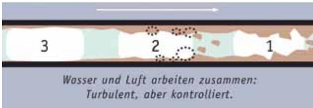
Abb. 5: Mobilisieren der Ablagerungen durch Luft- und Wasserblöcke
