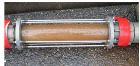
Abbildung 4: Schauglas zum Beobachten des Reinigungsvorgangs
