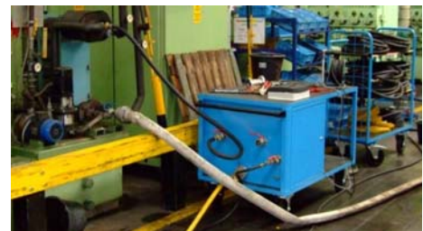
Abbildung 3: Reinigen eines Plattenwärmeübertragers mit mobiler Comprex®-Einheit
