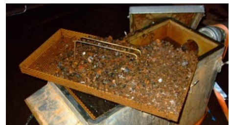
Abbildung 4: ausgetragene Ablagerungen in Spülbox
