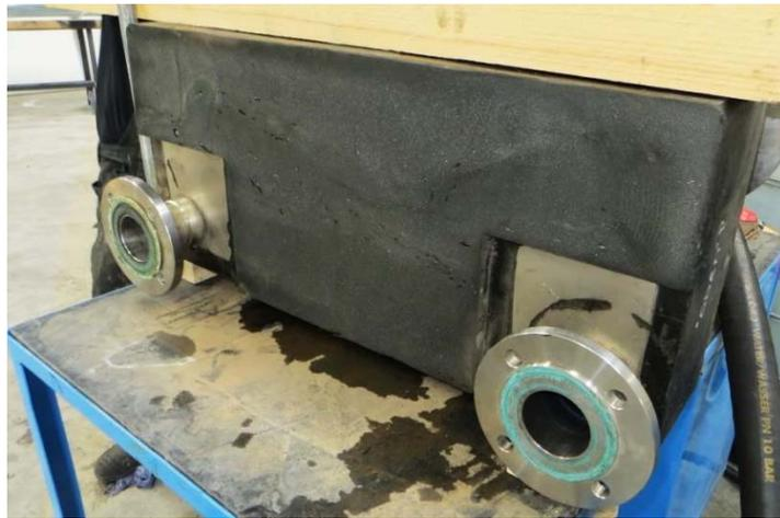
Abbildung 1: Plattenwärmeübertrager im ausgebauten Zustand
