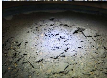
Abbildung 2: aus dem Plattenwärmeübertrager ausgetragene Ablagerungen
