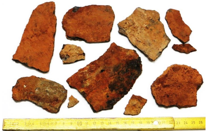
Abbildung 1: Aus dem System ausgetragene Ablagerungen
