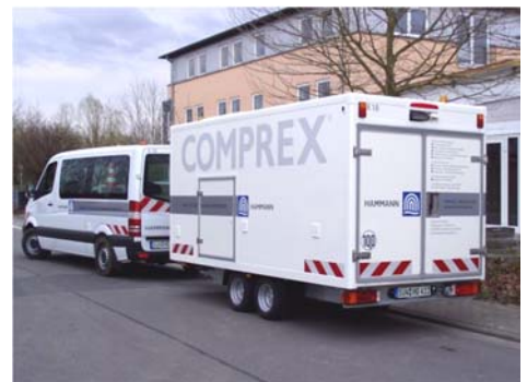
Abbildung 1: Complex ® -Einheit zur Bereitstellung von Druckluft
